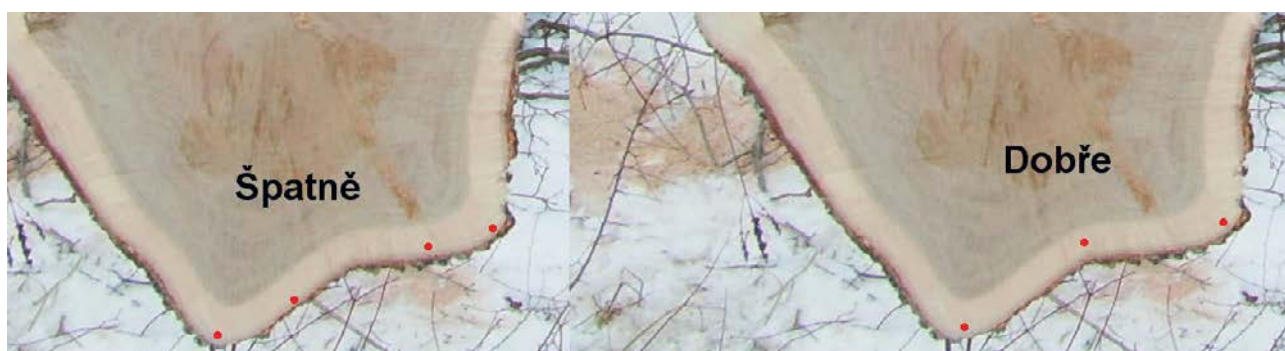
Obrázek 4-28 • Chybné a správné umístění snímačů tomografu na členitém obvodu (foto L. Praus).
