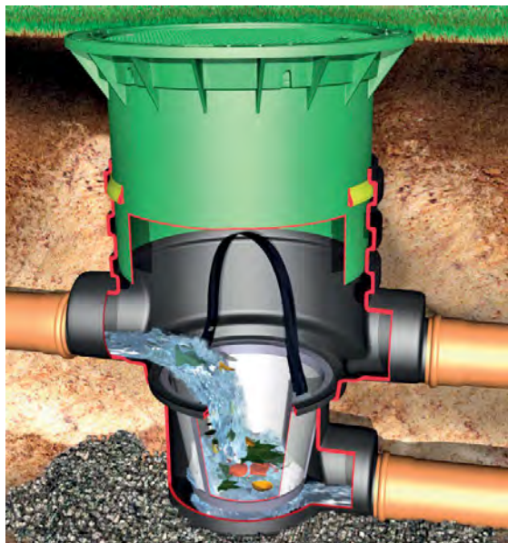
Obrázek 11-5 • Filtrační šachta GRAF GARANTIA DN400 s vyjímatelným košíkem, pojízdná do 3,5t. Vlevo nátok napojený na svod dešťové vody. Uvnitř se nachází vyjímatelný košík pro filtraci nečistot (převzato z www.rainshop.cz ).
