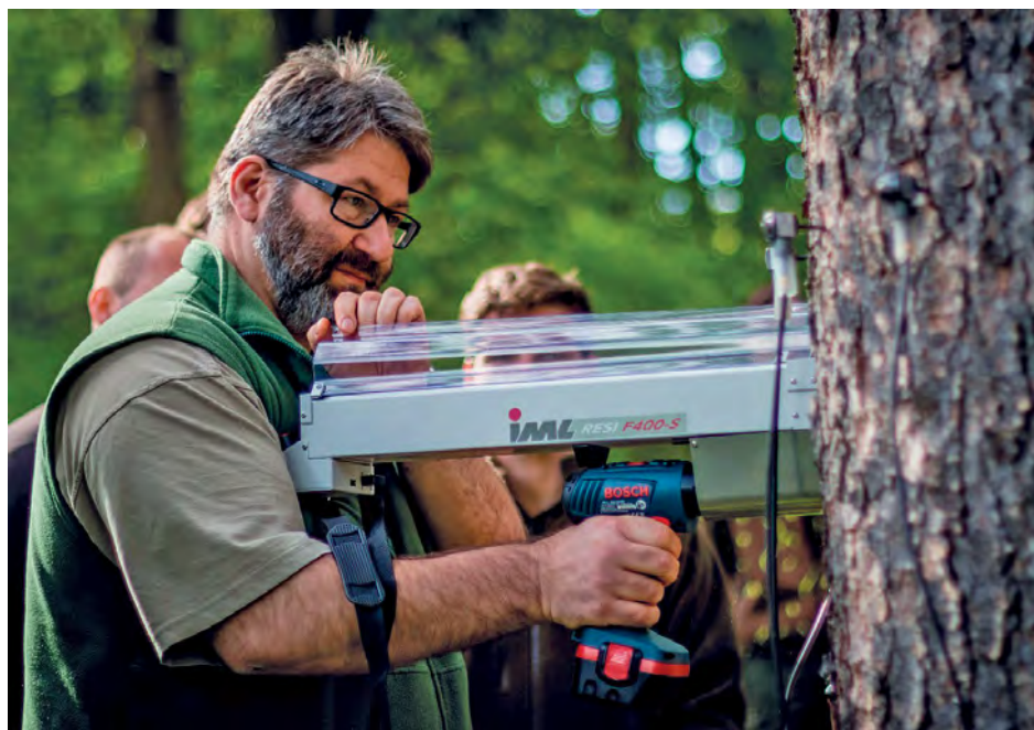
Obrázek 10-1 • Ing. Luděk Praus, Ph.D., zjišťuje přítomnost vad (defektů, hnilob, poruch) ve dřevě kmene stromu tzv. penetrometrickým měřením (odporovým vrtáním) pomocí speciálního přístroje Rezistograf IML Resi F400-S s wolframovým vrtákem, který měří mechanický odpor dřeva při radiálním vrtání napříč letokruhy. Výsledky vrtání se automaticky zaznamenávají na papírovou pásku přístroje pomocí integrované termotiskárny. Jsou zakreslovány pomocí grafické křivky, kde je uveden řezný odpor v závislosti na hloubce vrtání. Místa s větší hustotou se vyznačují vyšším odporem a v grafu jsou znázorněna jako vrcholy, oproti tomu místa s nižší hustotou (vadami, hnilobami či jinými poruchami dřeva) jsou zakreslována jako nižší body (foto archiv J. Rozsypálka).
