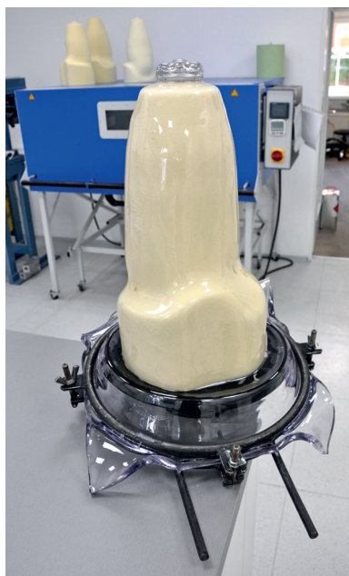
◄ Obr. 3.11 Model z PUR pěny, na němž je natažen termoplast – materiál vhodný pro výrobu zkušebního protetického lůžka. V pozadí je možno vidět speciální pec pro zahřívání termoplastu.
