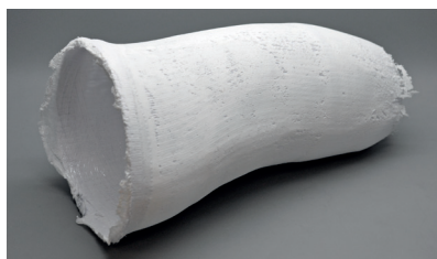
Obr. 3.10 Speciální punčocha sycená pryskyřicí (po vychladnutí a zatuhnutí), která představuje negativní model amputačního pahýlu pro zhotovení transtibiálního protetického lůžka.
